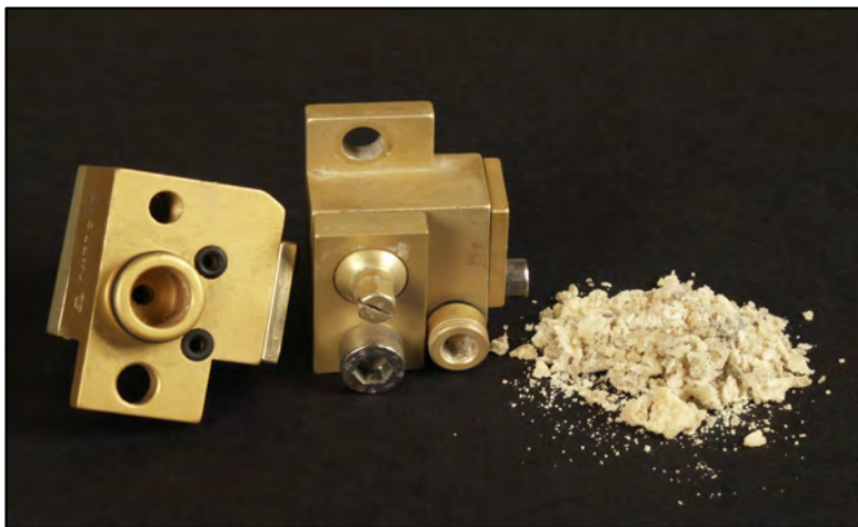
mechanisch entfernte Innenverkrustung / mechanically removed internal contamination
